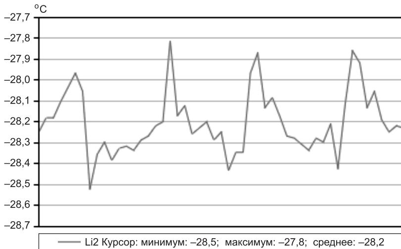
Рис. 2. Изменение температуры на защитном слое НВФ
