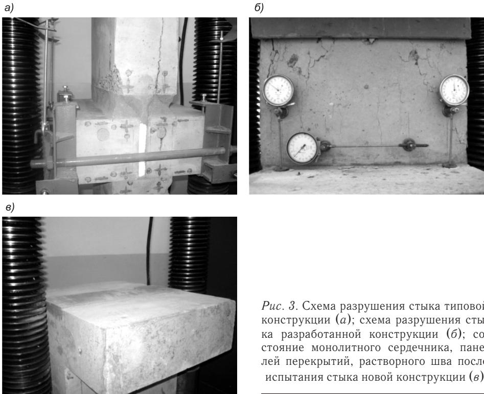
Рис. 3. Схема разрушения стыка типовой конструкции (а); схема разрушения стыка разработанной конструкции (б); состояние монолитного сердечника, панелей перекрытий, растворного шва после испытания стыка новой конструкции (в)
