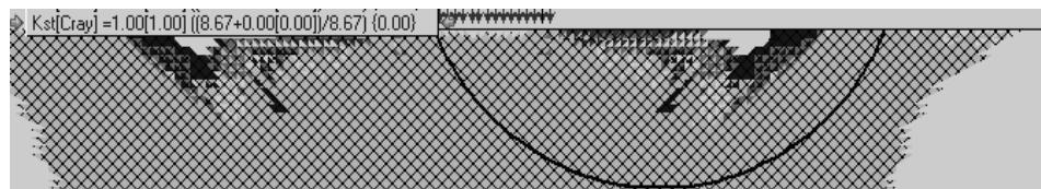
Рис. 3. Зоны «пластичности» в основании гибкого штампа при  $k_{st \min} = 1,00$ ,  $p_u = 1,36$  МПа (вариант Г. Крея)
