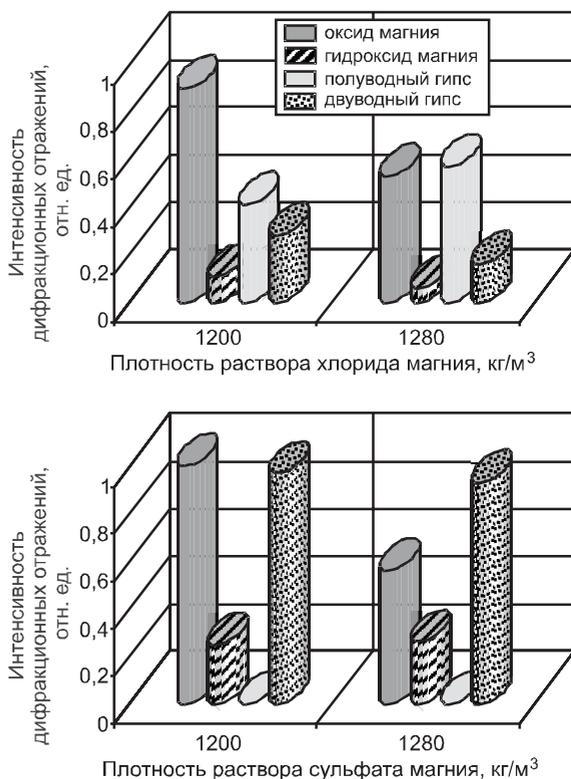
Рис. 2. Влияние вида затворителя на содержание основных фаз сульфомагнезиального камня длительного твердения
