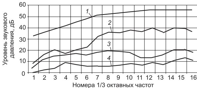
Рис. 1. Частотные характеристики изоляции воздушного шума оконного блока ОП ОСП 15-15 ГОСТ 30674-99 с двухкамерными стеклопакетами СПД 4М<sub>1</sub>-12-4М<sub>1</sub>-12-4М<sub>1</sub> при различных режимах проветривания (по результатам испытаний в звукомерных камерах)
