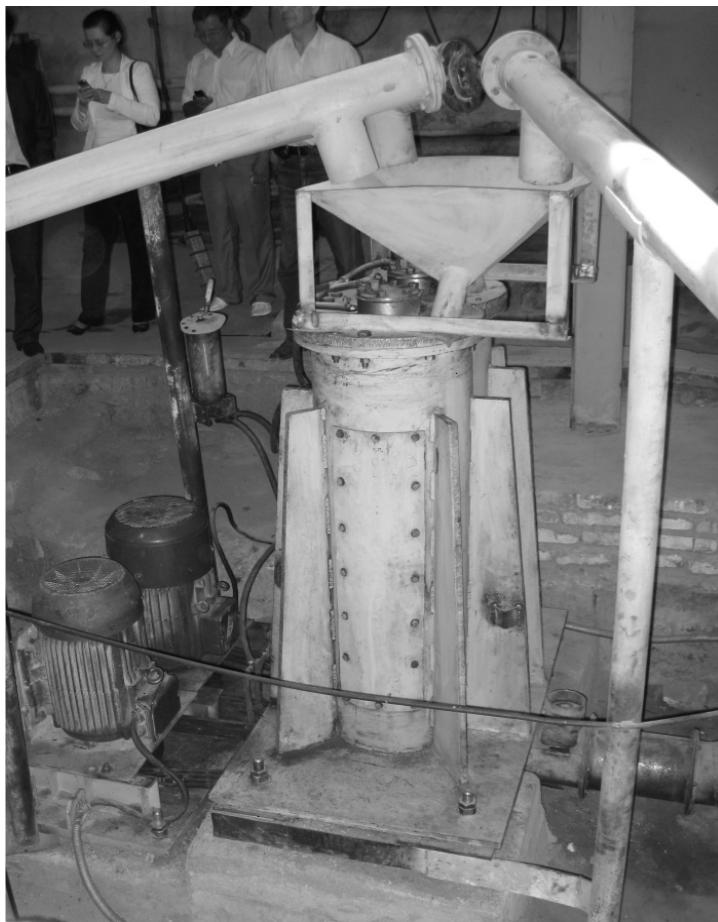
Рис. 1. Мельница ударного импульса
