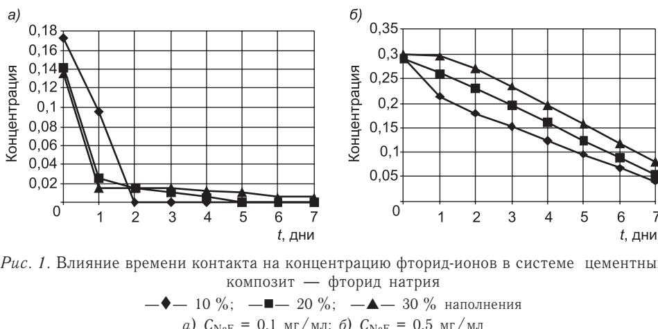
Рис. 1. Влияние времени контакта на концентрацию фторид-ионов в системе цементный композит — фторид натрия
