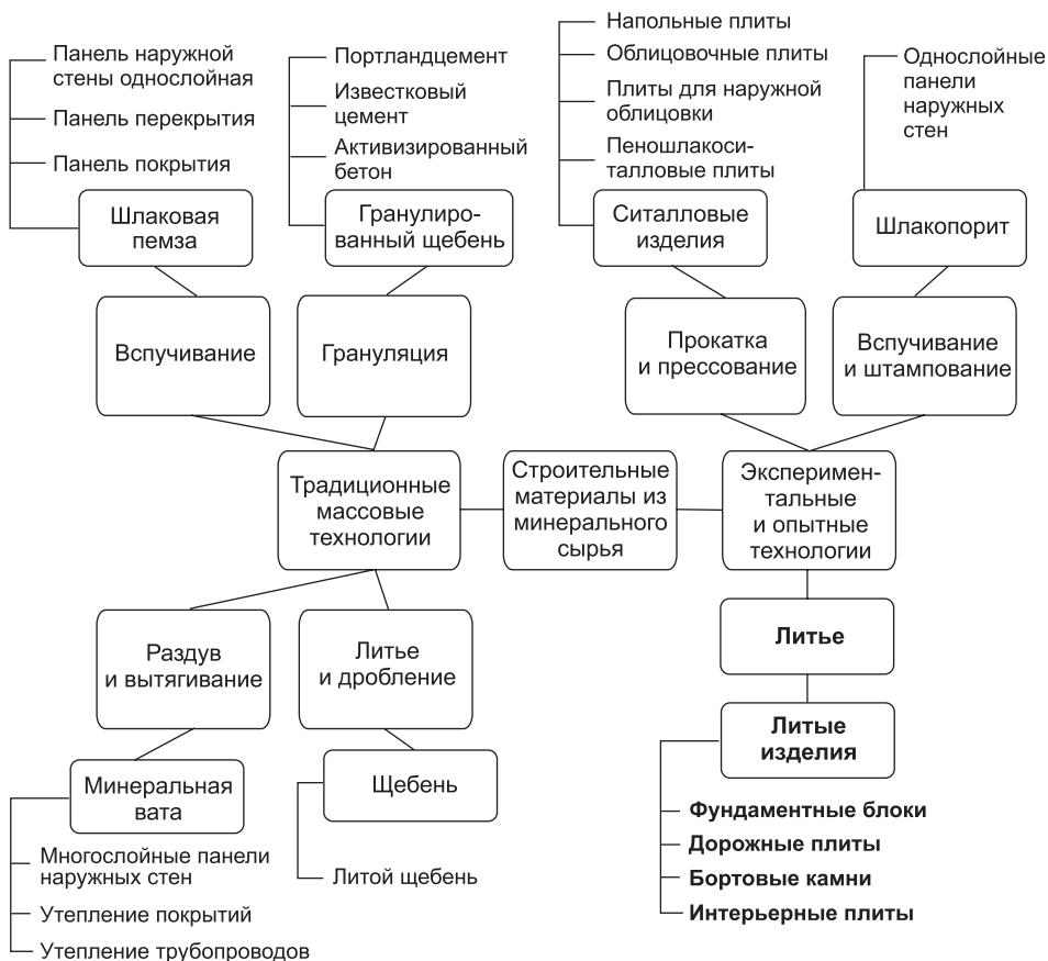
Рис. 1. Классификация строительных материалов на минеральной основе
