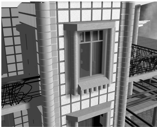
Рис. 3. Фрагмент фасадной части здания из пенобетонных лего-блоков
