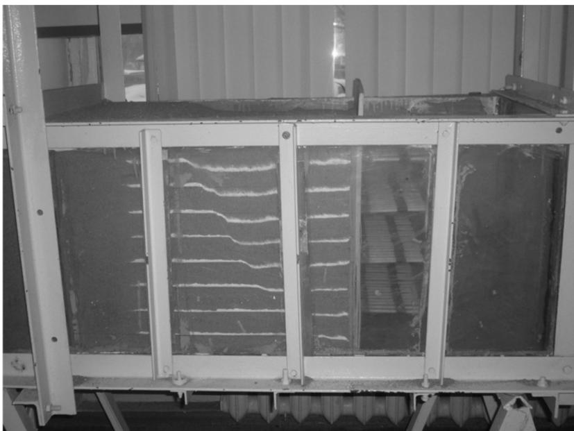
Рис. 3. Следы призмы обрушения за армогрунтовой «стеной»; высота откоса  $H = 0,48 \text{ м}$ , длина армоэлементов  $l = 0,375H$ , их диаметр  $d = 6 \text{ мм}$ , шаг по горизонтали  $b = 3d$ , по вертикали  $h = 0,2H$
