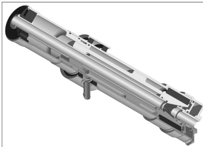
Рис. 2. Переносная пневмоударная машина со сквозным осевым каналом
