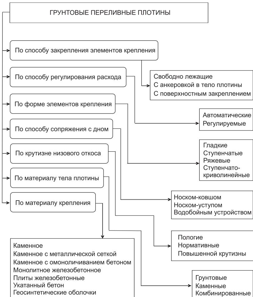
Рис. 6. Классификация грунтовых переливных плотин
