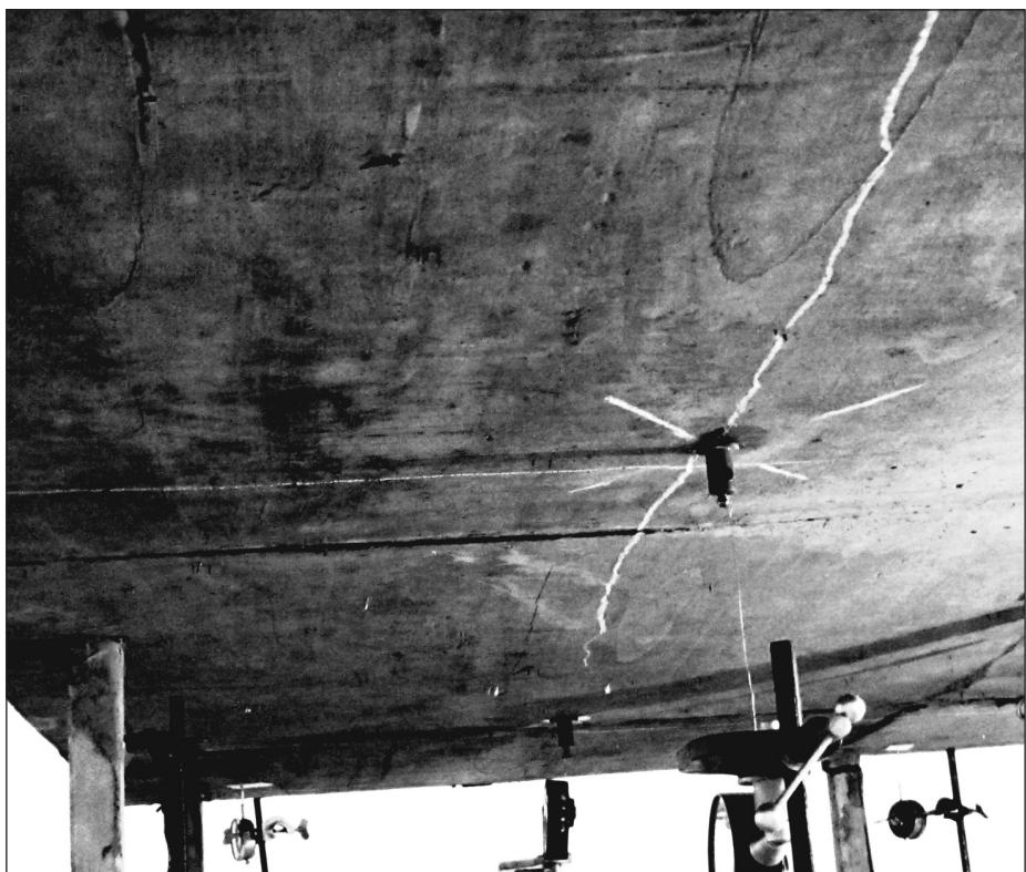
Рис. 2. Трещины на нижней поверхности экспериментальной модели каркаса
