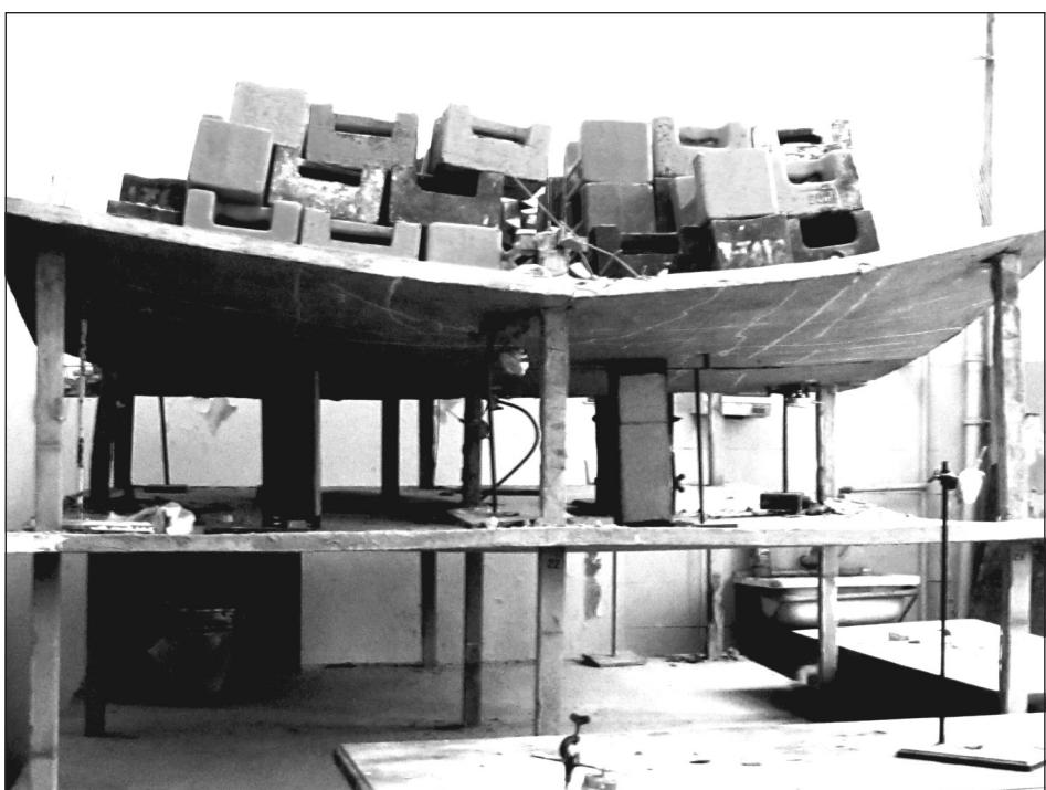
Рис. 3. Разрушение модели каркаса в результате среза по периметру колонны
