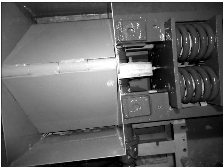
Рис. 2. Опытно-промышленная установка пресс-валкового измельчителя с устройством для равномерной и направленной подачи материалов
