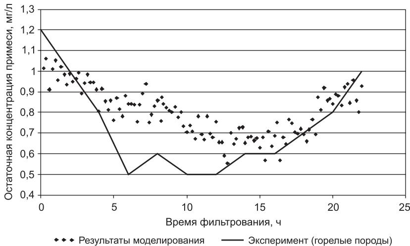
Рис. 3. Сравнение результатов моделирования для загрузки, состоящей из горелых пород
