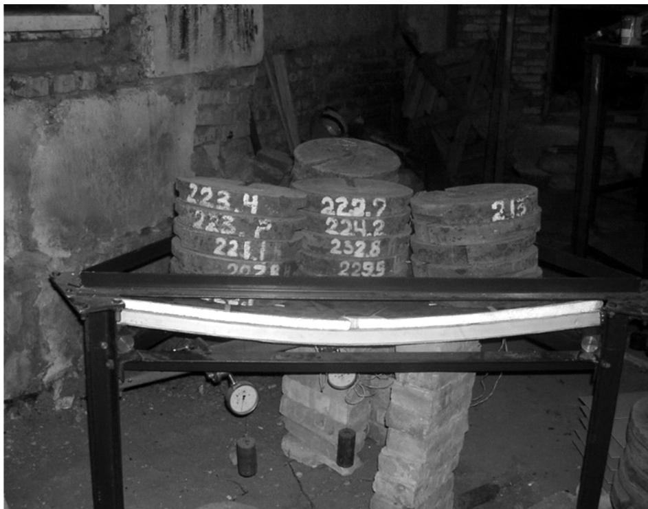
Рис. 4. Панель П-30 на стадии разрушения
