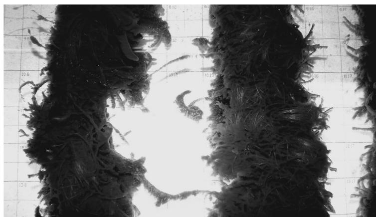
Рис. 3. Распределение иммобилизованного ила на ершовой загрузке в квазистационарном процессе седиментации
