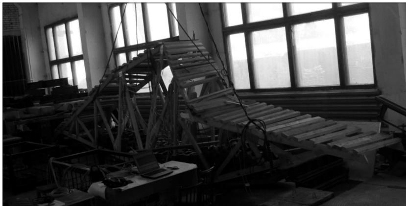
Рис. 9. Конструкция фермы после разрушения
