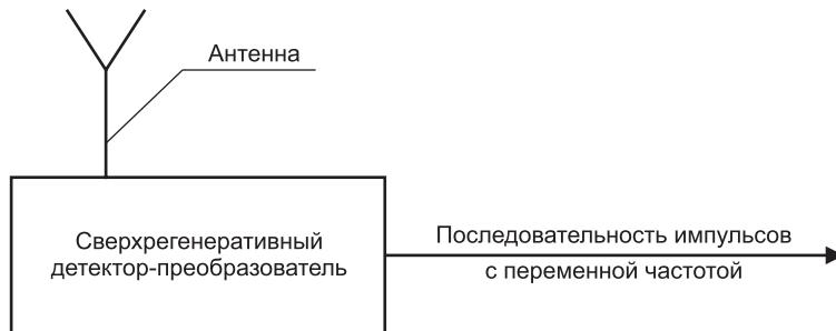
Рис. 1. Измеритель объема с использованием простого сверххреженеративного детектора-преобразователя
