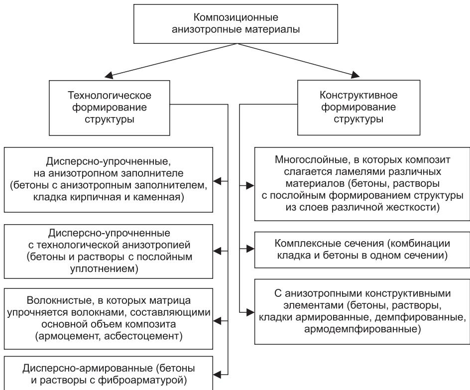
Рис. 1. Классификация КАМ по структуре
