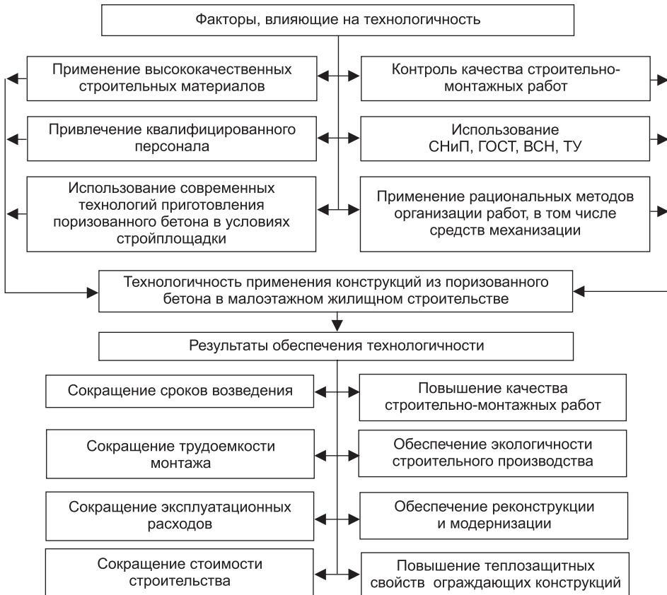
Рис. 3. Схема взаимосвязи факторов, влияющих на технологичность процесса применения поризованного бетона в малоэтажном строительстве
