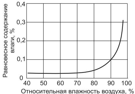
Рис. 1. Сорбционная кривая алюмосиликатных микросфер
