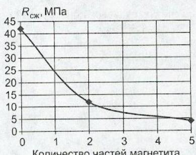
Рис. 1. Прочность РЗК от содержания магнетита (давление прессования 1 МПа)
