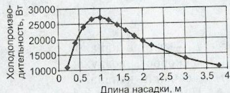
Рис. 4. Зависимость холодопроизводительности испарительной насадки от ее длины
