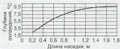
Рис. 2. Зависимость глубины охлаждения от длины испарительной насадки при использовании осевого вентилятора BO-14-320-6,3
