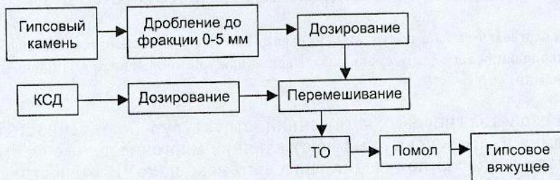
Рис. 2. Технологическая схема получения гипсового вяжущего с карбонатсодержащей добавкой
