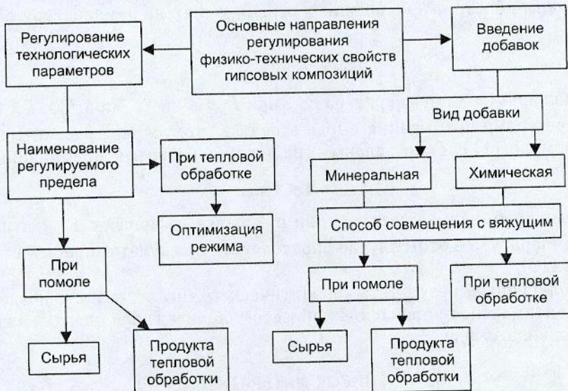
Рис. 1. Основные направления регулирования физико-технических свойств гипсовых композиций при получении
