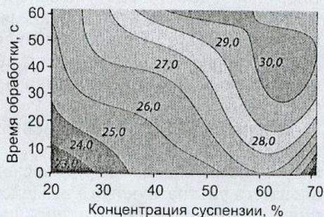
Рис. 2. Прочность образцов после 28 сут нормального твердения, МПа
