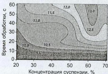
Рис. 1. Прочность образцов после 3 сут нормального твердения, МПа
