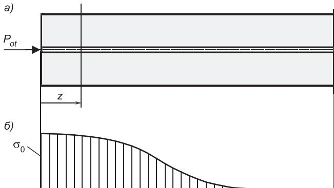
Рис. 4. Эквивалентная расчетная схема отпуска натяжения каната (а), эпюра условных напряжений отпуска в канате (б)
