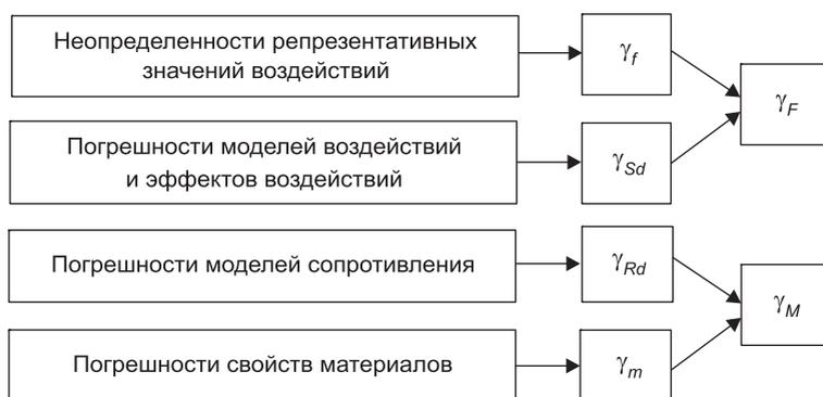
Рис. 7. Коэффициенты надежности, используемые в Еврокодах
