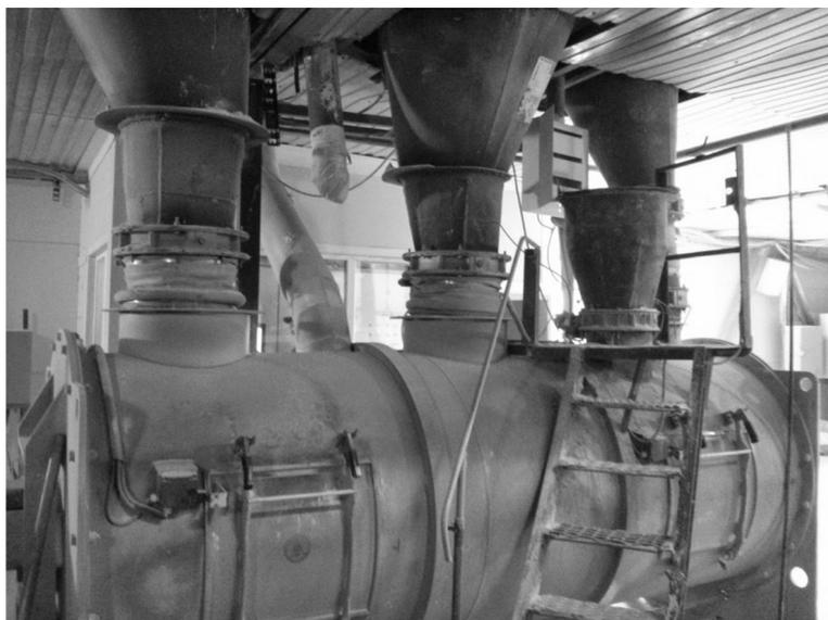
Рис. 3. Смесительная установка для приготовления сухой смеси
