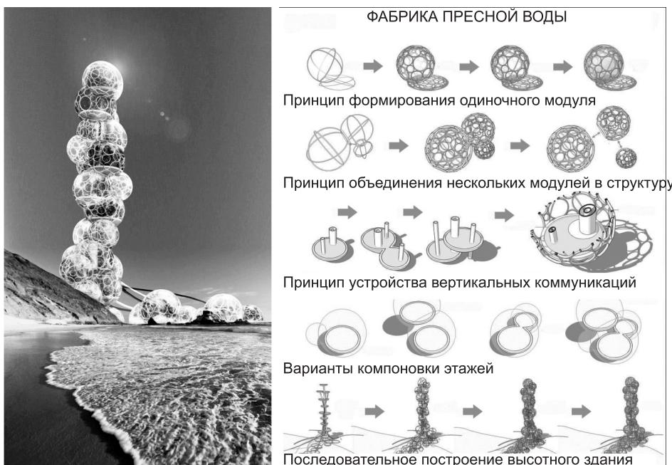
Рис. 2. Общий вид и принципы организации высотного здания «Фабрика пресной воды»
