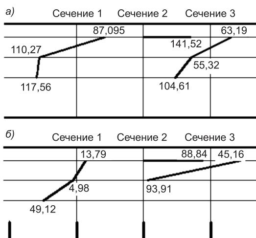
Рис. 3. Распределение усредненных деформаций ( $10^{-5}$ ) при нагрузке 4 кН
