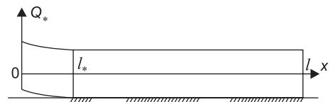
Рис. 2. Возникновение зоны отслоения при отрыве балки от плиты
