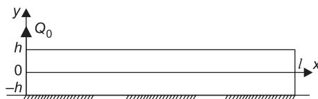
Рис. 1. Схема нагружения упругой балки, частично приклеенной к жесткой плите
