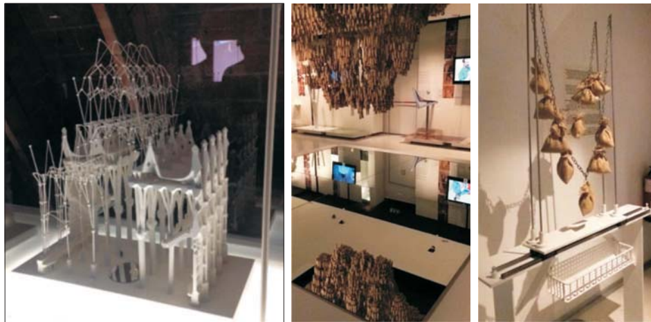
Рис. 6. Метод макетирования с использованием грузов и зеркал. Музей А. Гауди в г. Реус. Фото Т.В. Дончук
