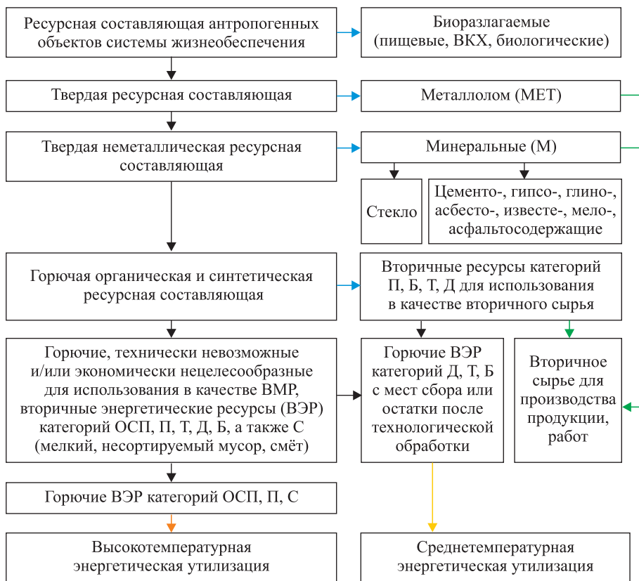
Рис. 7. Последовательная функциональная схема преобразования ВР
