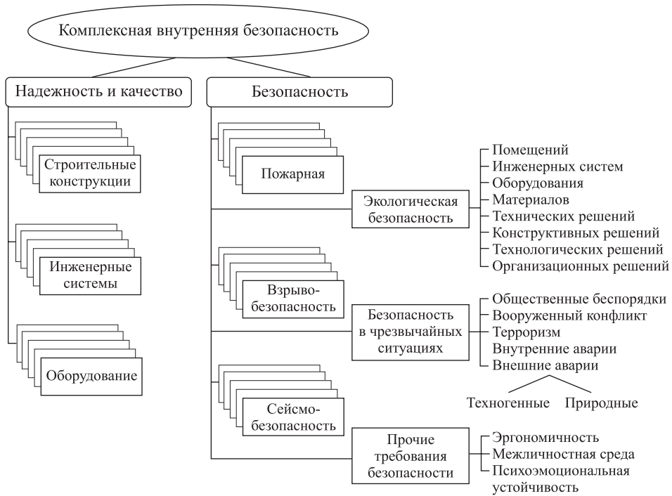
Рис. 4. Комплексная внутренняя безопасность
