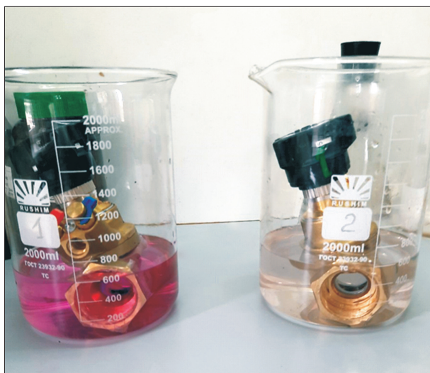
Рис. 4. Воздействие на балансировочные клапаны Danfoss гидроксида натрия
