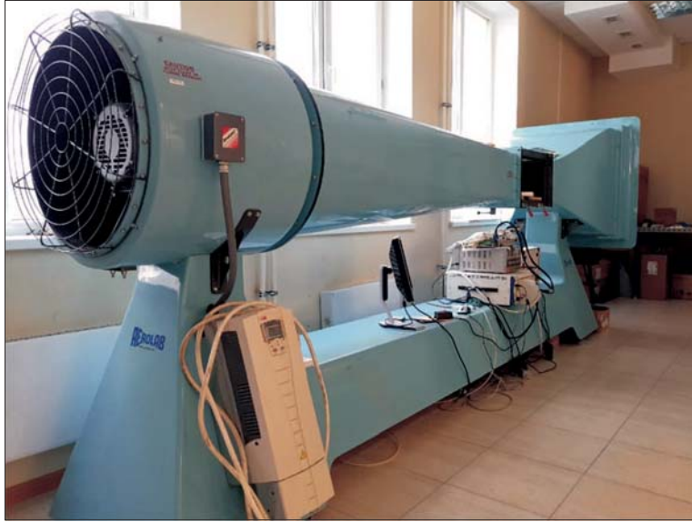
Рис. 1. Автоматический лабораторный комплекс для исследований в аэродинамической трубе AeroLab
