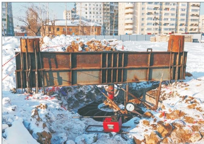
Рис. 6. Смонтированная установка штамповального испытания
