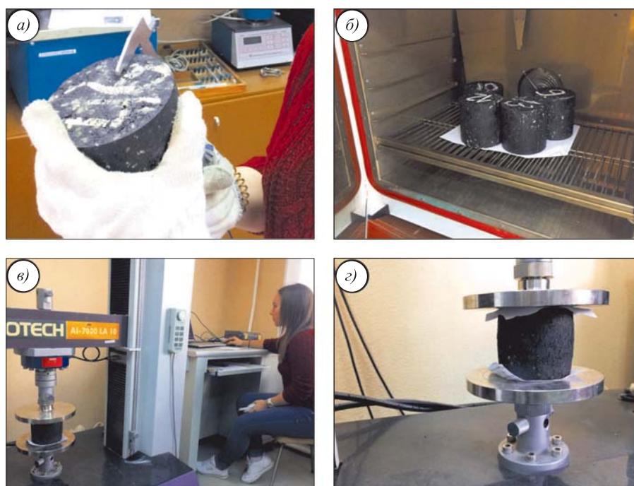
Рис. 2. Иллюстрации этапов испытаний асфальтобетонных образцов a – измерение геометрических размеров образца, которые вводятся в программу испытаний в качестве исходных данных; б – термостатирование образцов до требуемой температуры (10, 25 и 50 °С); в – проведение испытания и работа оператора; г – деформирование образца с образованием дефектов
