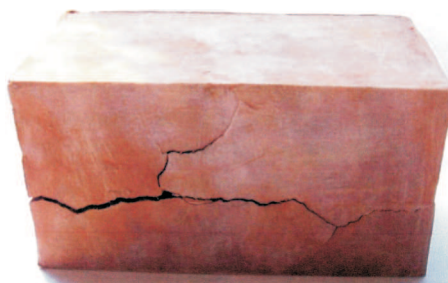
Рис. 4. Образец из бейделлитовой глины, обожженный при 1000 °С
