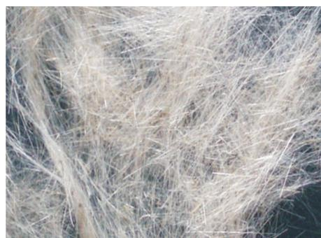
*Рис. 1. Микрофотография минеральных волокон ( $\times 300$ ), полученных из золошлаковых отходов*
