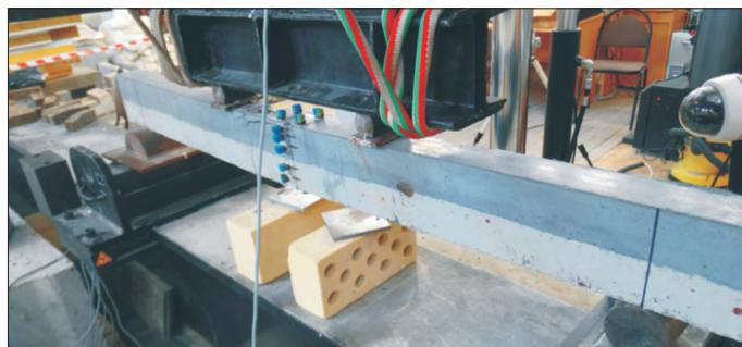
Рис. 2. Устройство для испытания двухслойных элементов, армированных продольной арматурой из АСК
