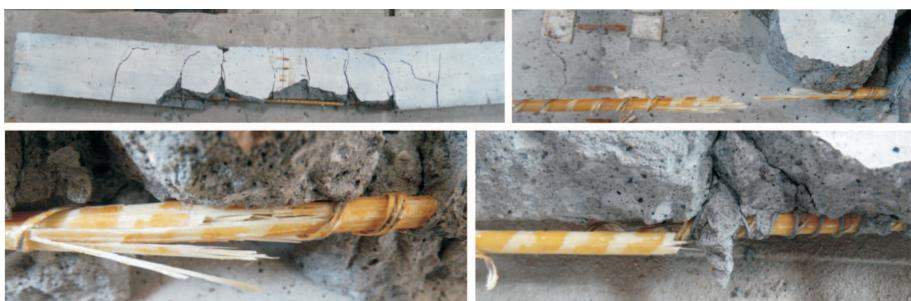
Рис. 5. Характер разрушения элементов с  $p_f = 0,45\%$
