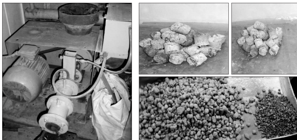
Рис. 2. Общий вид гранулятора для получения гранулированного крупного заполнителя из растительного сырья и заполнитель различных фракций
