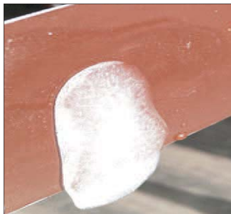
Рис. 4. Скатывание льда с супергидрофобной поверхности при температуре замораживания -5\text{ }^{\circ}\text{C}
