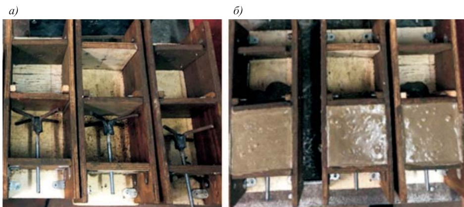
Рис. 6. Изготовление базовых образцов для испытания сцепления
