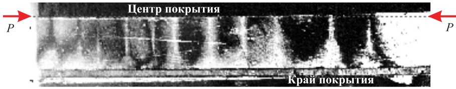
Рис. 5. Картина интерференционных полос в фотоупругом покрытии
