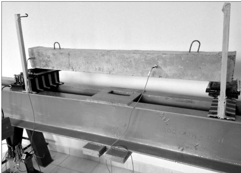
*Рис. 2. Испытание целой ж/б перемычки*
