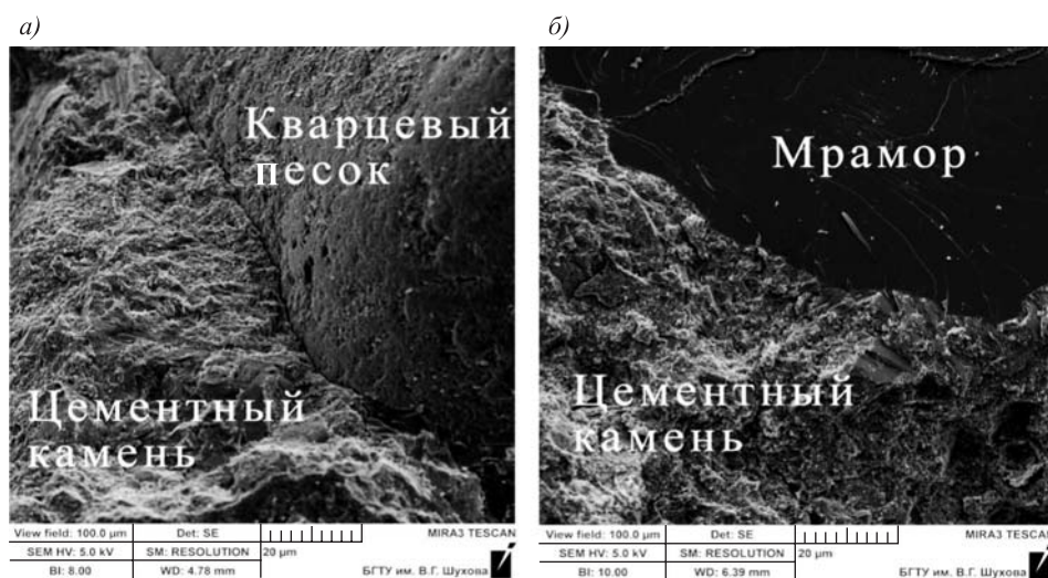
Рис. 5. Контактная зона между мелким заполнителем и цементной матрицей бетона кварцевого (а) и мраморного песка (б)
