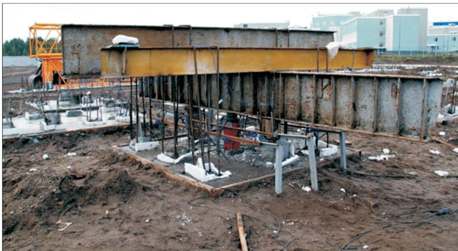
Рис. 2. Стенд для испытания свай статической нагрузкой
