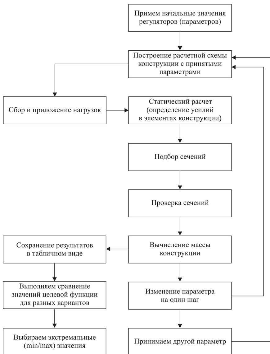
Рис. 1. Структурная схема проектирования
