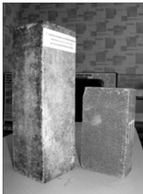
Рис. 1. Блок и кирпич из динаса (плотность 2 г/см<sup>3</sup>, линейные размеры: 380×130×120 и 150×130×65 мм), термообработка 250 °C
