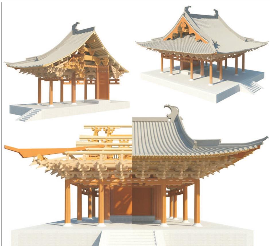
Рис. 4. Дадянь храма Баогосы: разные виды и разрезы построенной модели
