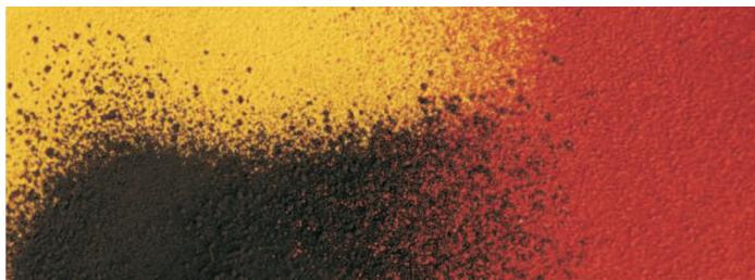
После достижения требуемой температуры устройство для прокаливания отключают. Экспериментально установлено, что пигмент из отходов водоподготовки характеризуется хорошими технологическими качествами: однородностью состава, высокой степенью дисперсности и диспергируемости.
