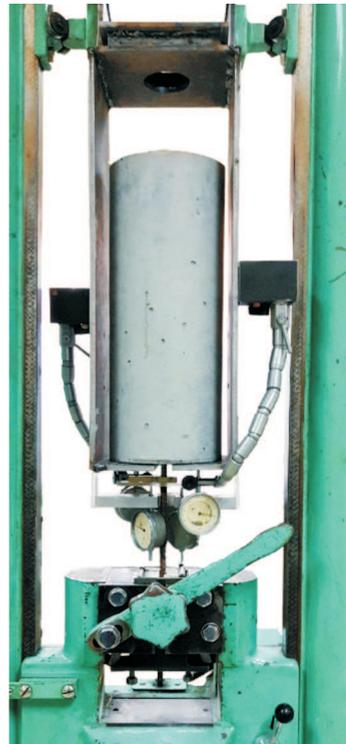
сцепления арматуры с бетоном, на каждом шаге приращения нагрузки осуществлялась ее выдержка до статического равновесия образца. После чего фиксировалось перемещение арматуры относительно торца бетонной обоймы  $\Delta_a$ . На рис. 6 светлыми точками представлены результаты испытаний коротких и длинных образцов. Сплошные линии соответствуют результатам их статистической обработки.
