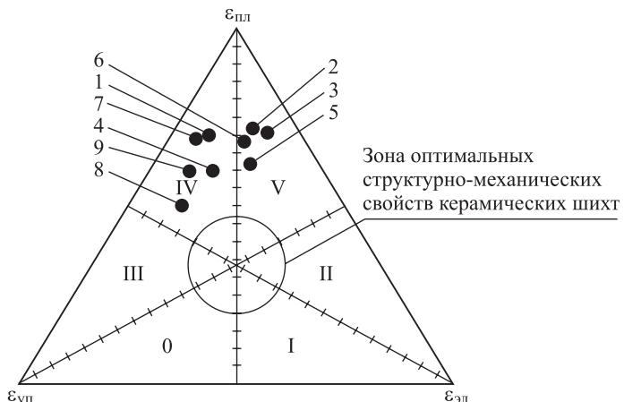
Рис. 4. Тройная диаграмма и таблица приведенных деформаций 6 структурно-механических типов по С.П. Ничипоренко для шихт состава
