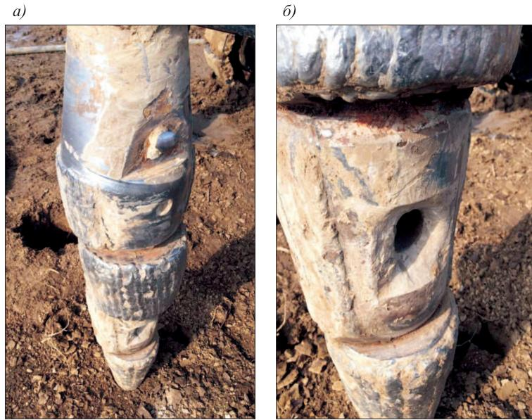
Рис. 6. Модификация раскатчика скважин с полым валом и выходным отверстием
