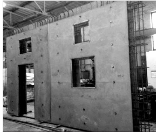
Рис. 1. Готовый к транспортировке и монтажу армоблок внутренней стены с дверным проемом и проходками для кабелей и трубопроводов
