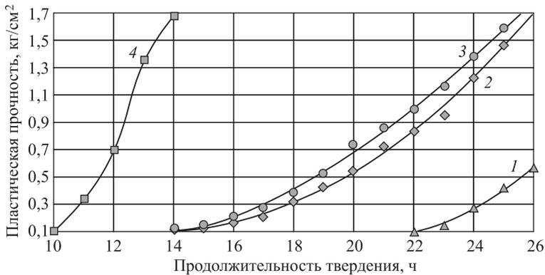
Рис. 2. Пластическая прочность пенобетона при содержании в сухой смеси добавок
