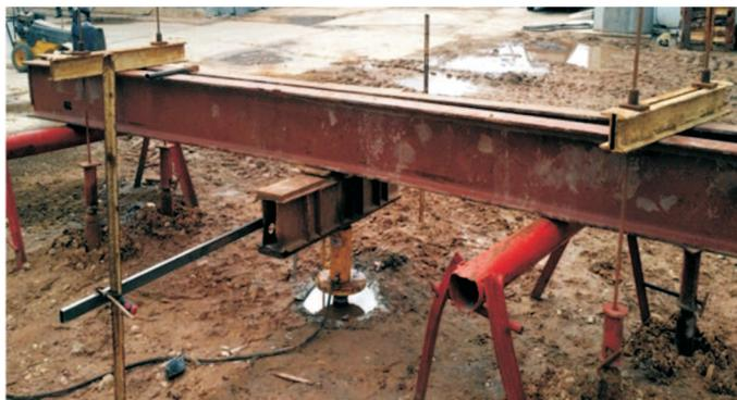
Рис. 3. Установка для испытания свай методом релаксации напряжений
